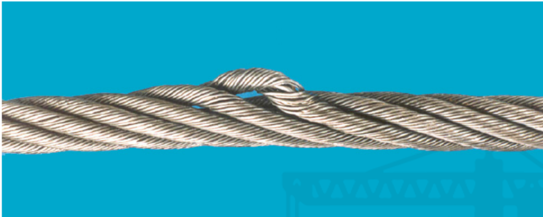
شکل ب-۴- برآمدگی رشته های بافته شده / اعوجاج
