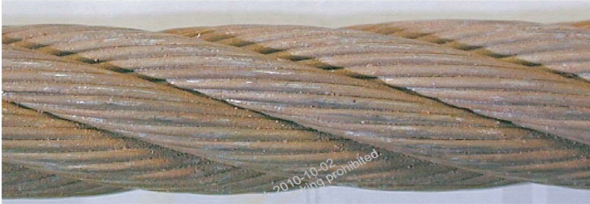
شکل ح ۱- آغاز زنگ زدگی سطحی که می توان با پاک کردن زدود، سطحی بودن-مقدار تمایل به از رده خارج ساختن ۰٪/صفر.
