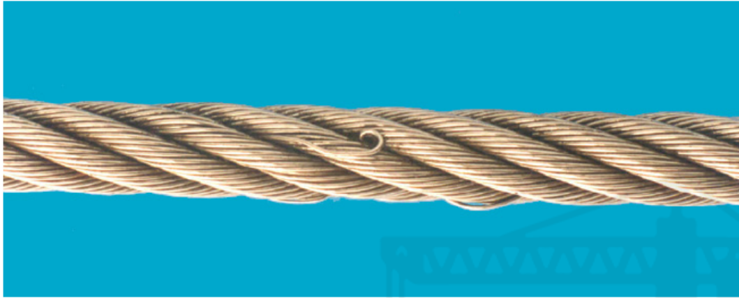
شکل ب-۱- برآمدگی سیم
