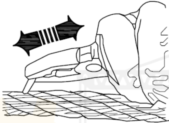
شکل ۵ - برداشتن سیم بیرون آمده
