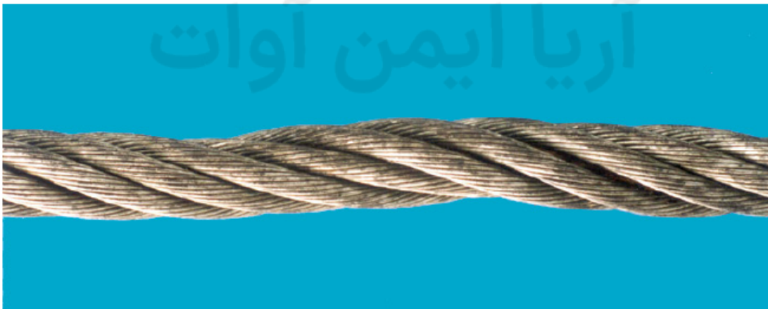
شکل ب-۳- کاهش مقطعی قطر طناب ( رشته بافته شده فرو رفته)
