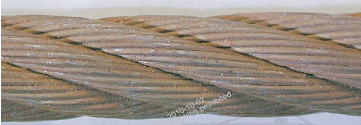
شکل ح ۱- آغاز زنگ زدگی سطحی که می توان با پاک کردن زدود، سطحی بودن-مقدار تمایل به از رده خارج ساختن ٪ صفر.
