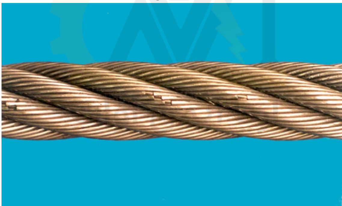
شکل ب ۱۳- شکست سیم های تاج
