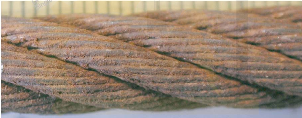
شکل ح ۲- طناب در حین لمس شدن زبر بوده-زنگ زدگی متداول-مقدار تمایل به از رده خارج ساختن ٪ ۲۰.
