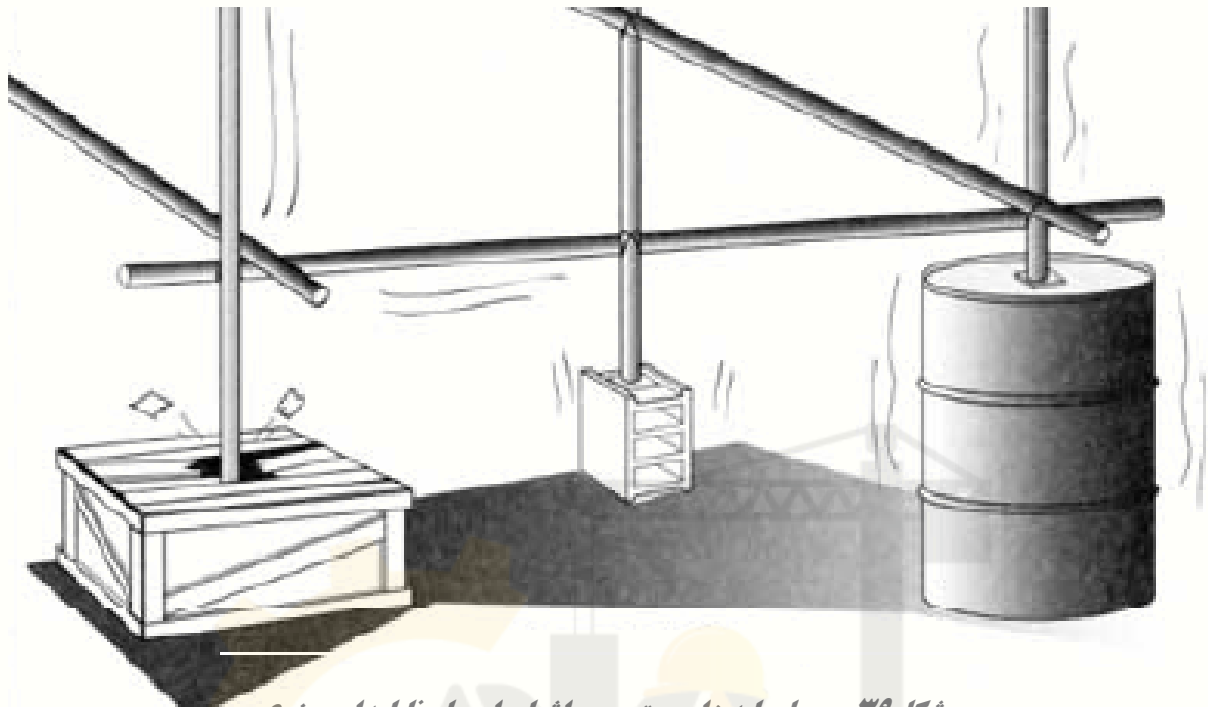
شکل ۳۹- محل پایه دار بست روی اشیا و اجسام ناپایدار ممنوع
