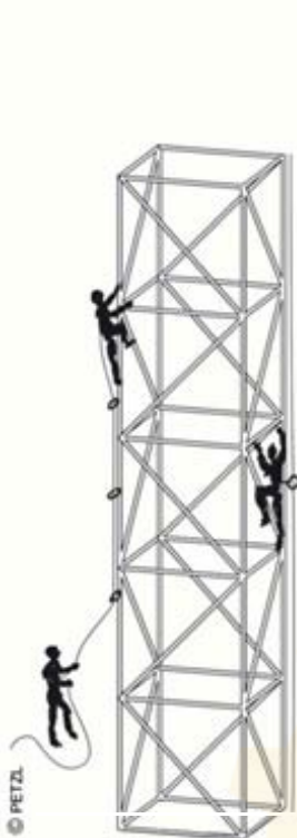
شکل ۶۵- اتصالات محدود کننده با روش ریلی
