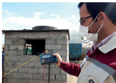
تست چاه ارت یا میله ارت نباید با روش های قدیمی و مرسوم قدیمی انجام شود ، باید سعی برآن باشد که با روش های جدیدتری تست چاه ارت را انجام داد. از جمله این روشها میتوان به روش افت ولتاژ ( fall of potential ) اشاره کرد
